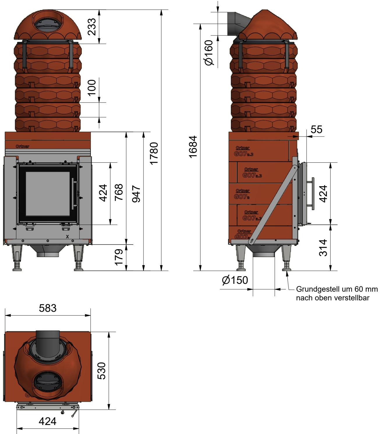
Alle Höhenangaben gelten bei einer Mörtelfugenstärke von 3 mm, einer Fasermattenstärke von 3 mm (im zusammengepressten Zustand) und vollständig nach unten geschraubtem Grundgestell.
